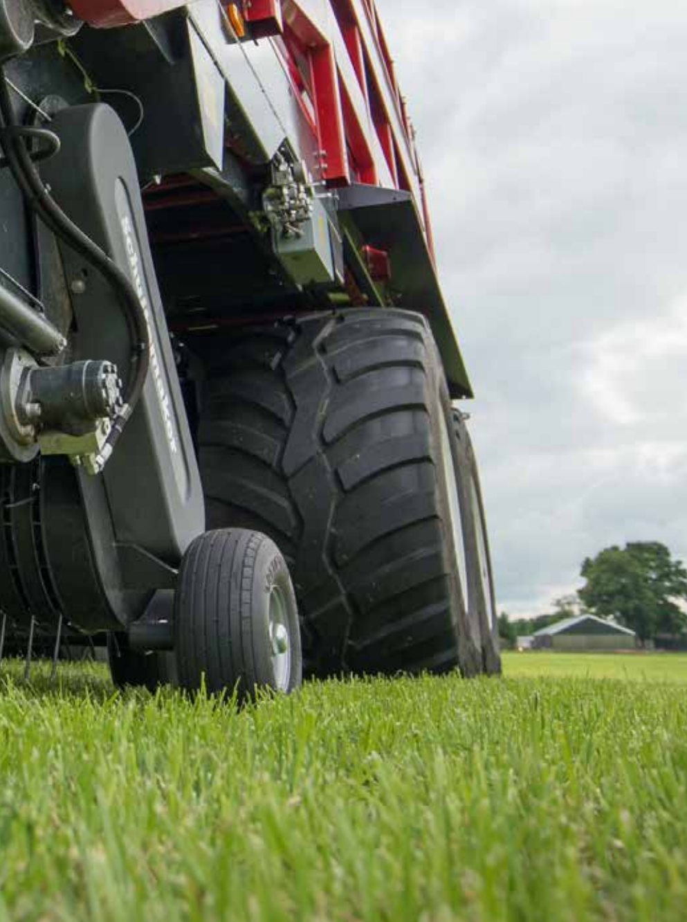
Pendeltandemachse 16 t Tandem ungelenkt
