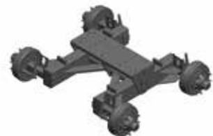
Pendeltandemachse 16 t Tandem ungelenkt
