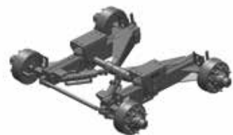
Pendeltandemachse 24 t nachlauf gelenkt
