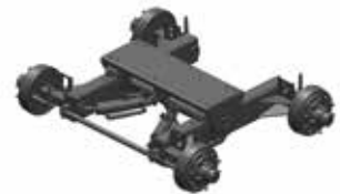
Pendeltandemachse 18 t nachlauf gelenkt
